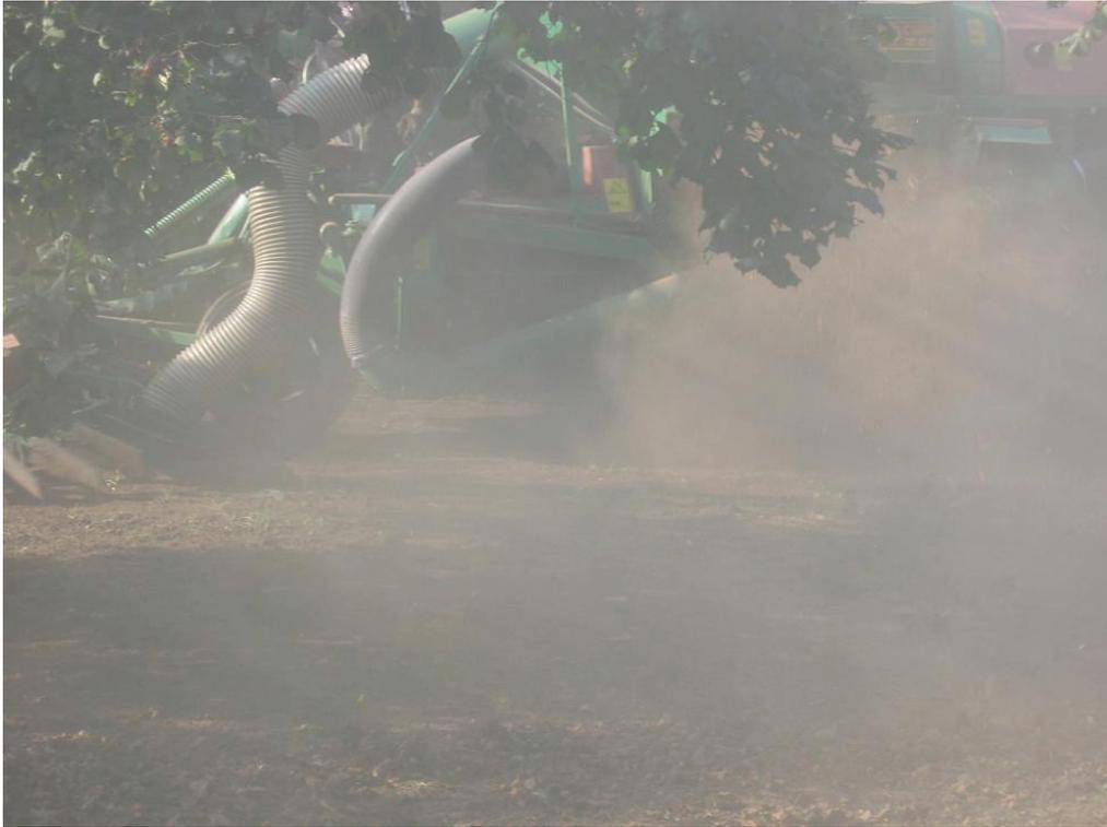
**Figura 5:** Aerodispersione di polvere durante l'utilizzo di spazzole raccattatrici
