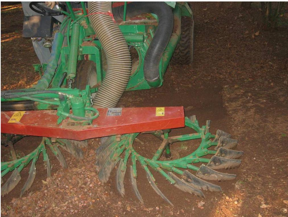
**Figura 6:** Spazzole raccattatrici in una macchina semovente
