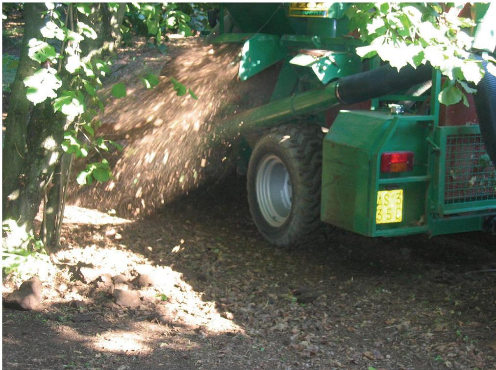
**Figura 2:** Macchina aspiratrice in raccolta
