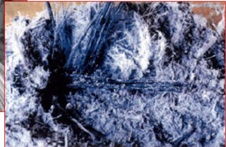
Con la excepción del crisotilo, todas las formas de amianto son muy resistentes a los ácidos y a los álcalis y todos se descomponen a altas temperaturas (*800-1000 °C*).
